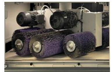
Bestückung mit 8 Lamellenwalzen für perfekte Verrundung
