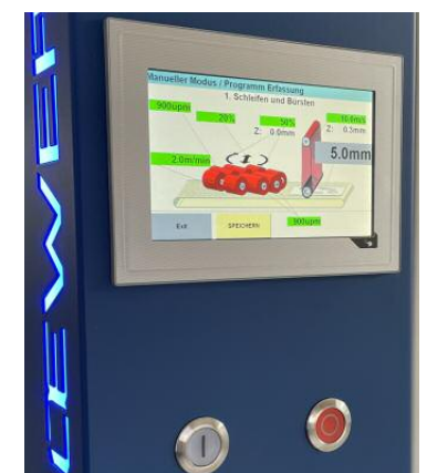
Touchpanel Steuerung mit Programmspeicher
