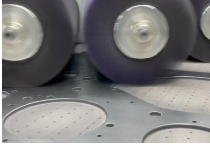
Kantenverrundung bis R=2mm
