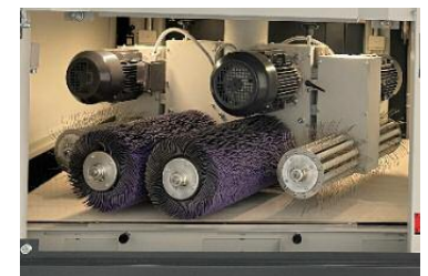
Bestückung mit 4 Lamellenwalzen und 4 Drahtwalzen für Verrundung und Oxidentfernung
