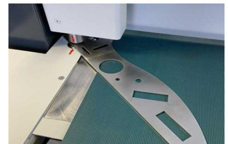
Motorische Blechdickeneinstellung, optional mit automatischer Abtastung
