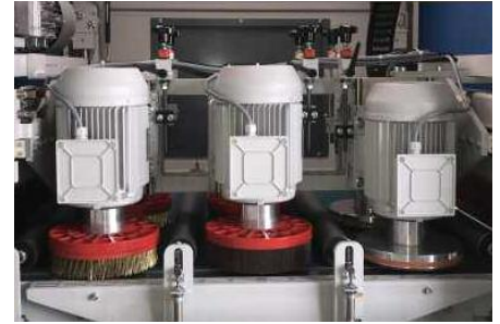
Bestückung zum Entgraten, Verrunden und Oxidschichtentfernen in einem Arbeitsgang
