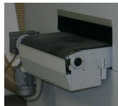
Transportbandabstreifer mit Auffangbehälter
