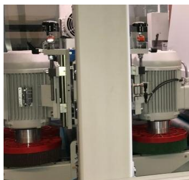
Discstation mit vier großen Discs
