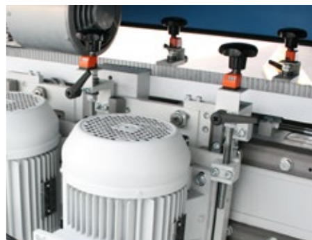
Einzelverstellbare Discs zur einfachen Kompensation unterschiedlicher Werkzeugdicken
