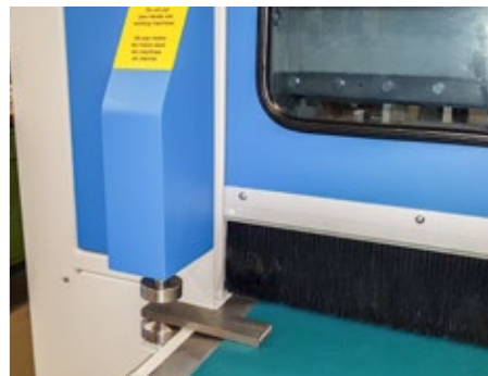
Motorische Blechdickeneinstellung, optional mit automatischer Abtastung
