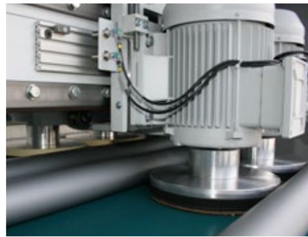
Vier rotierende und oszillierende Discs für 360° Bearbeitung
