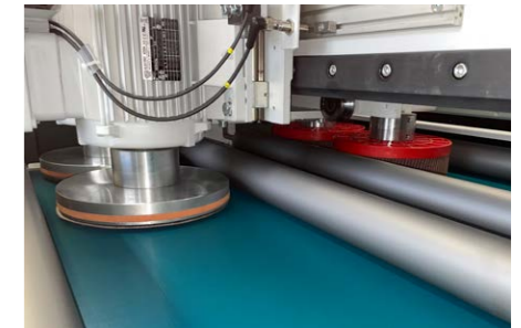
Vier rotierende und oszillierende Discs für 360° Bearbeitung
