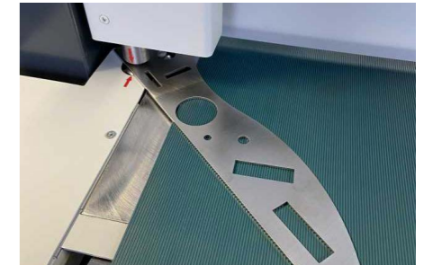
Motorische Blechdickeneinstellung, optional mit automatischer Abtastung
