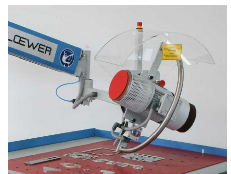
Schwenkbarer Schleifkopf 180 Grad für schnelle Verfügbarkeit von Entgrat- und Verrundungswerkzeug
